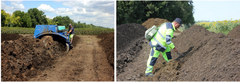
Рис. 4. Етапи дослідження аеробного компостування: а) аерація субстрату самохідним аератором BASKHUS A30; б) вимірювання показників субстрату (температура, вологість, рН)
